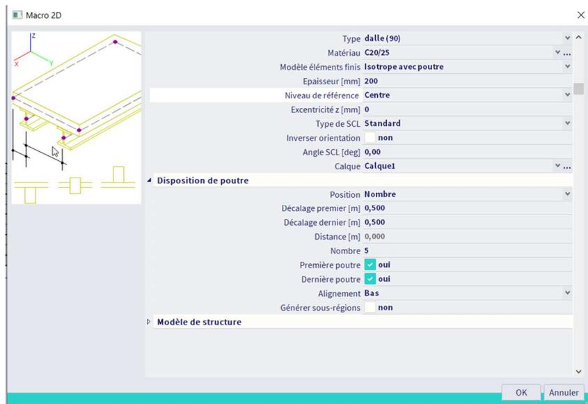
Tracer la plaque puis Echap , choisir la section el la forme des nervures
